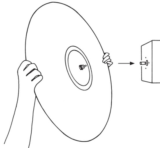
⑥ Scheibe im Uhrzeigersinn eindrehen / Screw the disc in clockwise / Tourner le disque dans le sens des aiguilles d'une montre / Avvitare il disco in senso orario
